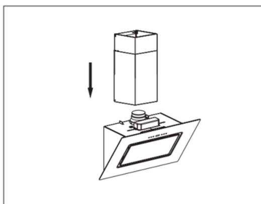
6. Соедините отверстия внешней части короба с корпусом вытяжки, закрепите внешнюю часть короба на корпусе. Направление показано на рисунке.
