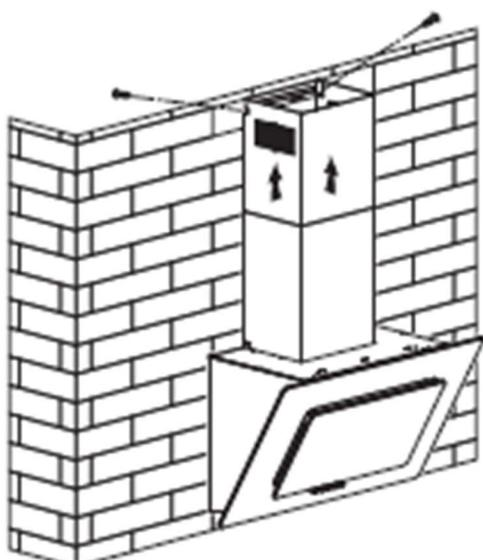
8. Выдвиньте внутреннюю часть кожуха на высоту саморезов, подвесьте кожух на саморезы за фиксирующую скобу. По отверстиям скобы отметьте и просверлите 2 отверстия диаметром 8 мм и глубиной 75~85 мм. Выровняйте фиксирующую скобу с отверстиями и затяните саморезами 5x60 мм.
