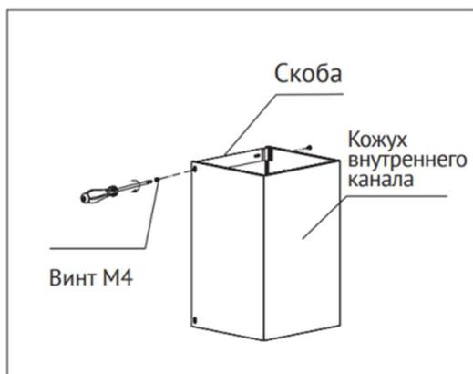
4. Прикрепите фиксирующую скобу к внутреннему телескопическому коробу винтами М4.
