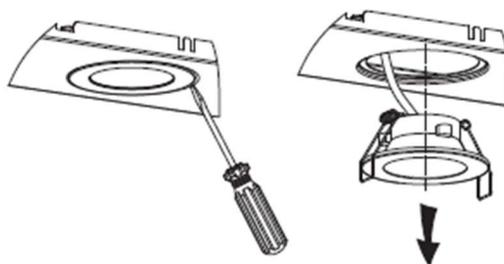
6. Замену следует осуществлять на светодиодную лампу только соответствующей мощности и технических параметров. Установите новую лампу в вытяжку, затем следуйте указанным выше шагам в обратном порядке для её подключения.
