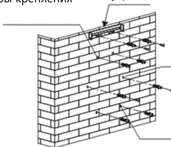
Отверстия для крепления корпуса вытяжки
