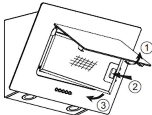
Для установки алюминиевого фильтра вставьте его в пазы в задней части корпуса вытяжки, затем нажмите на зажим на фильтре, вставьте фильтр в корпус вытяжки и отпустите зажим.
